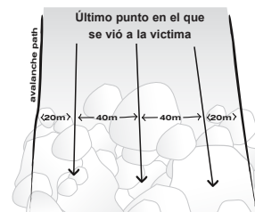
Ruta de señal de búsqueda con varios rescatadores (Desprendimiento superior a 40m de ancho).
